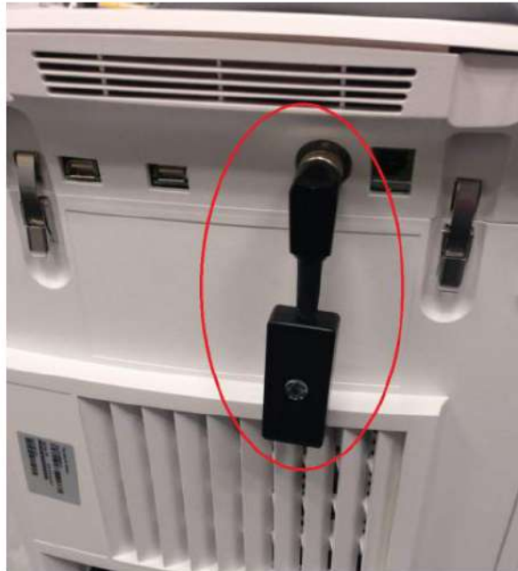
Figura 4.9: Puerto de conexión de dongle OPT
