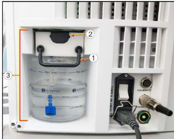
Figura 4.10: Llenado de depósito de Refrigerante
