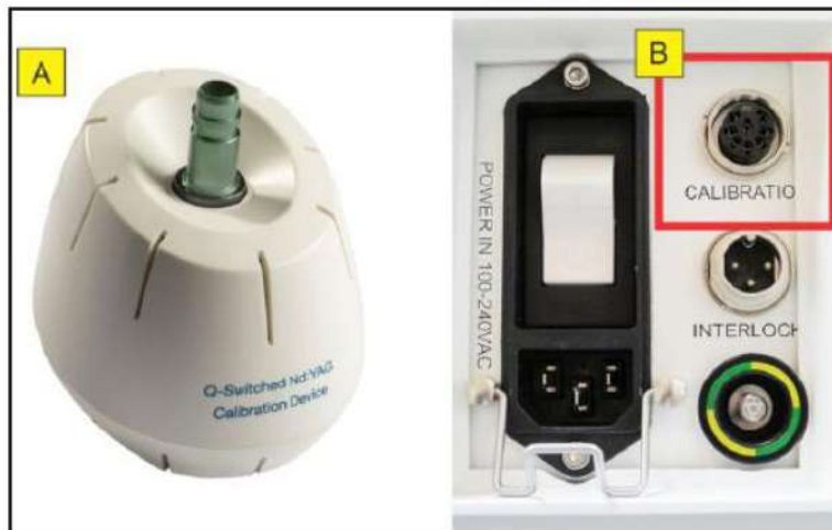
Figura 4.12: Conexión del dispositivo de calibración Q-Switched Nd: YAG al puerto del panel de servicio
