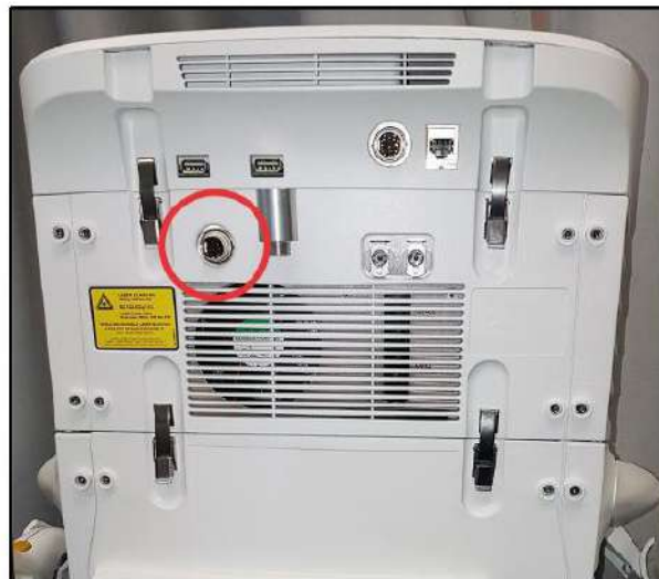
Figura 4.8: Conexión de Interruptor de pie
